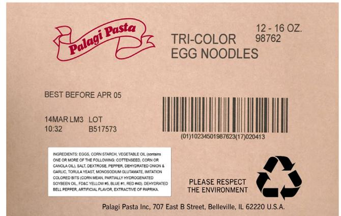
**Vorgedruckte Logos und Firmendaten. Etikett mit aufgeführtem Inhaltsstoff. Variable Daten werden mit dem Inkjet-Drucker inline gedruckt.**
